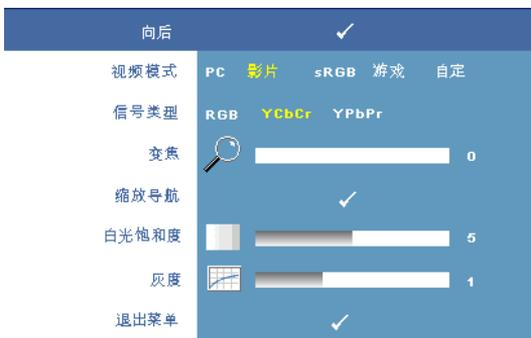
**视频模式**—根据投影仪的使用方式选择视频模式来优化显示：**PC**、**影片**、**sRGB**（提供更精确的颜色表示）、**游戏**和**自定**（设置您的首选设置）如果调整**白色饱和度**或**灰度**设置，投影仪将自动切换到**自定**模式。
