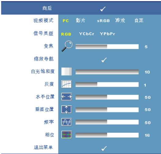
**视频模式** —根据投影仪的使用方式选择视频模式来优化显示：**PC**、**影片**、**sRGB**（提供更精确的颜色表示）、**游戏**和**自定义**（设置您的首选设置）如果调整**白色饱和度**或**灰度**设置，投影仪将自动切换到**自定义**模式。
