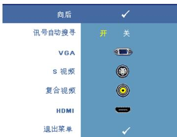
**讯号自动搜寻**—选择**开**（默认设置）自动检测可用的输入信号。当选择了**开**时，按控制面板 / 遥控器上的**信号源**可自动查找下一个可用的输入信号。
